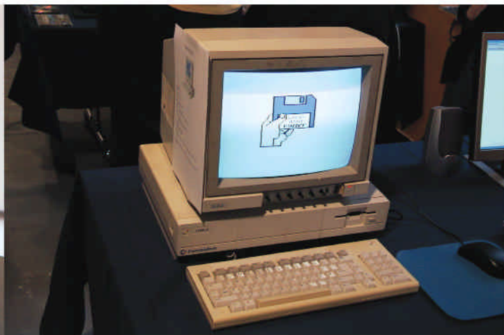
Amiga 1000 med den velkjente disketten i oppstarten, bare at på dette bildet spør maskinen etter KickStart, ikke Workbench...
